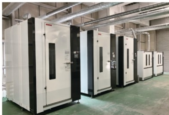
すすぎ工程でMA-Tによる消毒 ができるマットレス洗浄機
